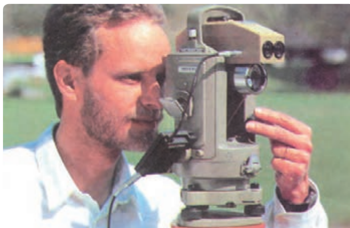
شکل ۲۳-۴ نصب فاصله‌یاب روی دوربین
