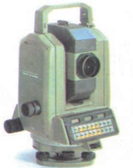
شکل ۲۴-۴ فاصله‌یاب در داخل دوربین نقشه‌برداری
