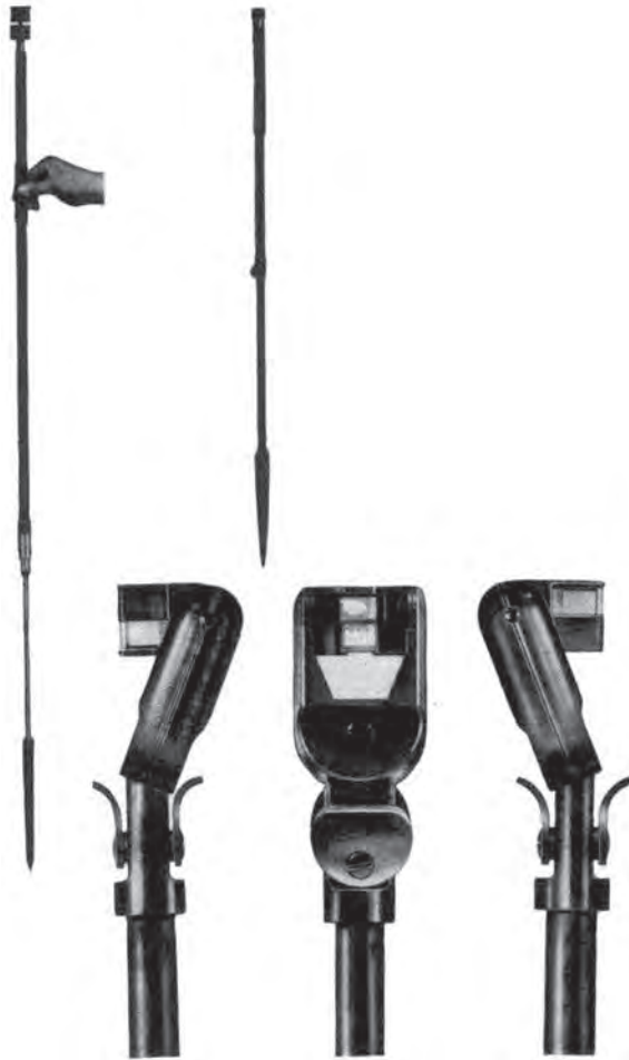
شکل ۸-۳- گونیای منشوری و پایه‌ی مخصوص آن
