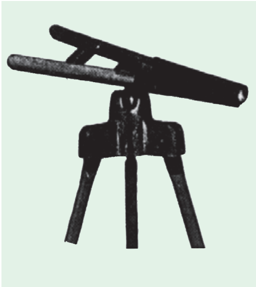
شکل ۳-۳- ژالون گیر و نحوه‌ی به کارگیری آن
