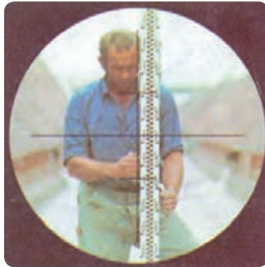
شکل ۱۴-۸- طریقه‌ی نگاه داشتن میر
